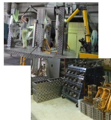
Сварочная система DEMMELER D28, Германия (2 ед.)
