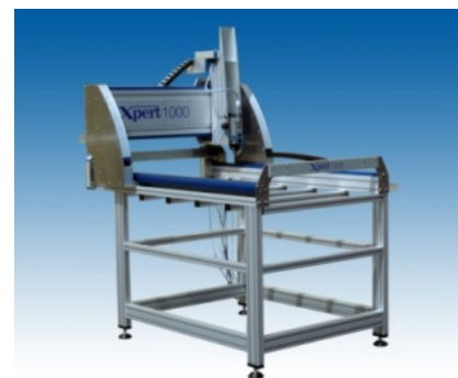
Фрезерно-гравировальная установка с ЧПУ Xpert 1000/180 Step-Four GmbH Германия (1 ед.)
