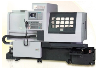
Автомат продольного точения с ЧПУ Golden 20S2 Тайвань (2 ед.)
