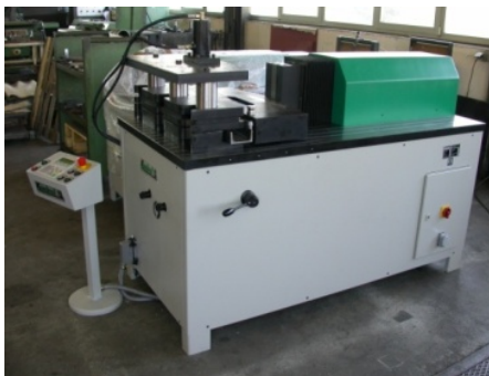
Комбинированная правильно-гибочная установка URM80E, Германия (1 ед.)
